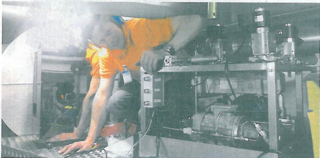
Mit Kraftstoff-Wasser-Emulsionstechnologie (KWE) macht die Firma Exomission (im Bild Mitarbeiter Piere Scosceria) Schiffsdiesel sauberer.
