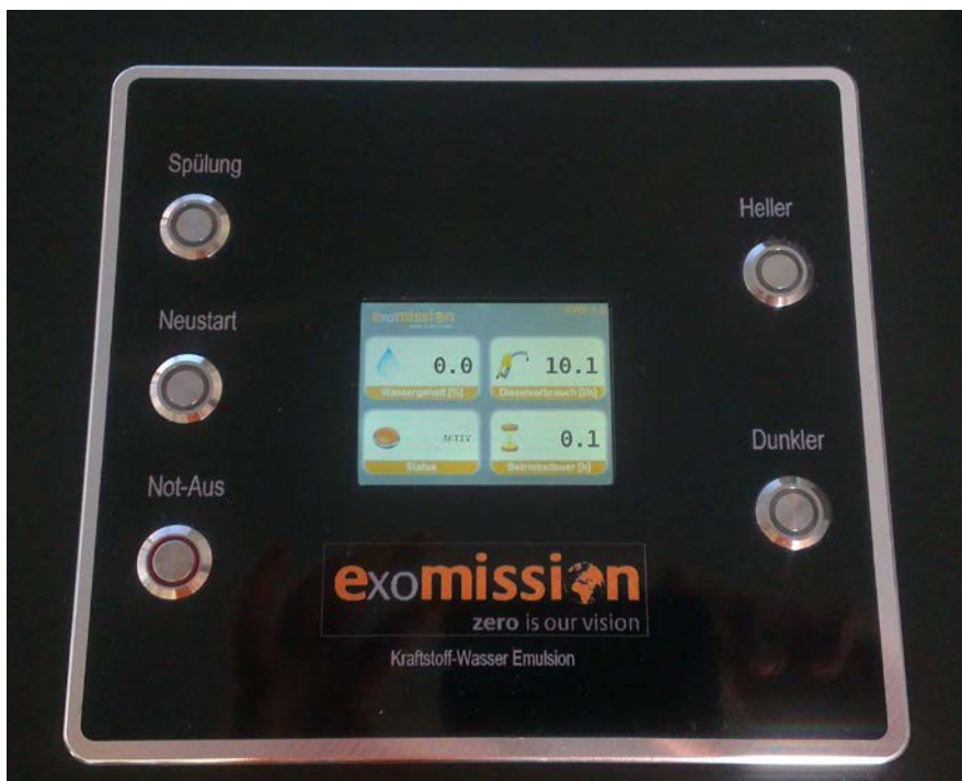
2) Im Steuerhaus wird dem Schiffsführer während der Fahrt das Vorhandensein und die Funktionsfähigkeit des KWE-Systems lediglich durch ein leuchtendes Display im rechten Teil der Instrumententafel signalisiert. Das Display zeigt neben dem KWE-Betriebszustand auch den aktuellen Dieserverbrauch und den Wasseranteil an.
