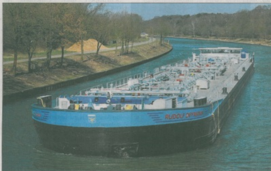
Premiere: Das Motorbinnenschiff Rudolf Deimann fährt als erstes Binnenschiff rußfrei dank Wassereinspritzung. Foto: C. Bartsch
