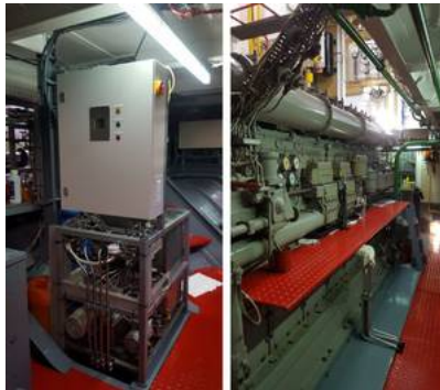
Die neu installierte KWE-Anlage (links) versorgt den alten Deutz 545 (rechts) mit Kraftstoff-Wasser-Emulsion.
