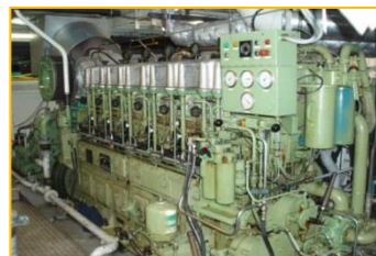
MS Aarburg • Hauptmaschine: ABC MDZC-166 A • 1.325 kW • Containerschiff • 135 m • 3.297 to.
