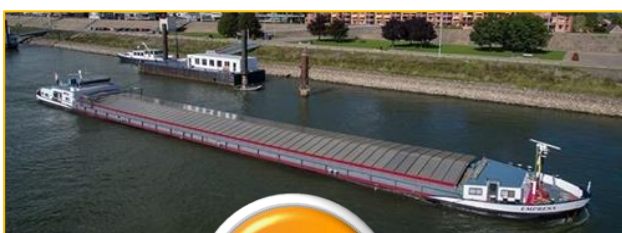
MS Empesa • Hauptmaschine: Deutz 545 • 745 kW • Trockengüterschiff • 86 m • 1.500 to.
