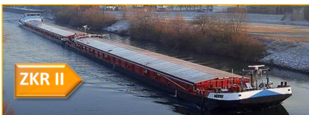
KV Heinz Hofmann • Hauptmaschine: ABC MDZC-166 A • 1.325 kW • Trockengüterschiff 186 m • 4.788 to.
