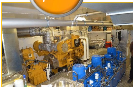
MS Rhenus Duisburg • Hauptmaschinen: 2 x CAT 3512C • 2 x 1118 kW und 2 x CAT C18 • 2 x 355 kW Trockengüterschiff • 110 m 2.900 to.
