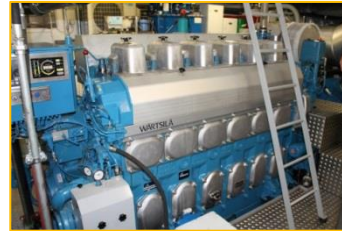
TMS Rudolf Deymann • Hauptmaschine: Wärtsilä 6L20 • 1.076 kW • Tankschiff • 110 m • 2.322 to.
