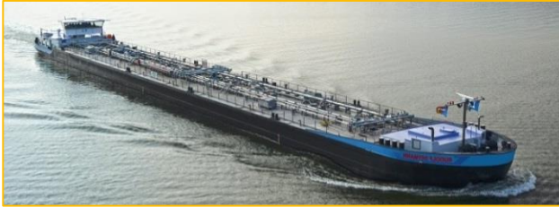
TMS Rudolf Deymann • Hauptmaschine: Wärtsilä 6L20 • 1.076 kW • Tankschiff • 110 m • 2.322 to.
