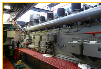
MS Empesa • Hauptmaschine: Deutz 545 • 745 kW • Trockengüterschiff • 86 m • 1.500 to.
