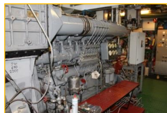
MS Schönrain • Hauptmaschine: MWM TBD 440 • 720 kW • Trockengüterschiff • 86 m • 1.724 to.
