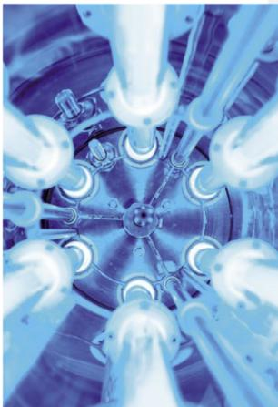
**Zur Eliminierung** der unerwünschten Wasserbestandteile gibt es verschiedene Methoden. Bei Einsatz von ultraviolettem Licht mit einer Strahlenlänge von rund **254 nm** und einer **Mindestintensität von 400 J/m<sup>2</sup>** kann man sicher davon ausgehen, dass **99,99% und mehr** aller am Strahler im Wasser vorbeifließenden Keime und Viren umweltfreundlich und zuverlässig inaktiviert werden.
