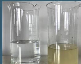
Flusswasser nach Sandfilterdurchgang
